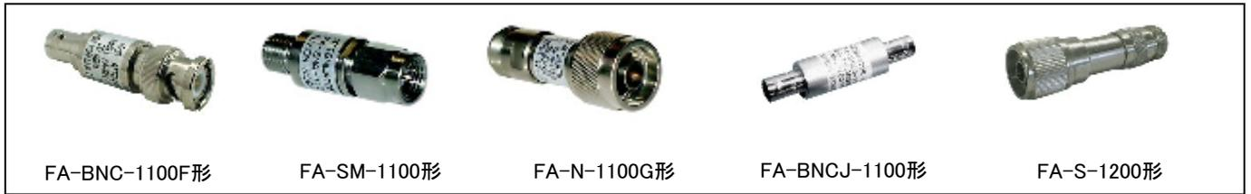
同軸管内に取り付けた抵抗体に通過電力の一部を吸収させ、通過するマイクロ波電力に一定の減衰を与えるもので、伝送回路の途中に置いて、レベル調節、減衰量測定における標準器、測定範囲の拡大手段、発振器と負荷とのマッチング用として広く用いられます。
