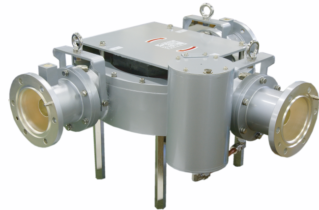
476MHz同軸管サーキュレータ 80kWCWに耐える構造 絶縁油充填方式
