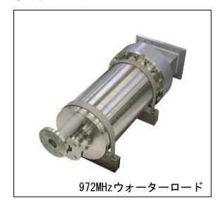
本器は水をマイクロ波電力吸収体として用い、発生した熱は水と共に外部の放出するような構造になっています。大電力用負荷として用いられるばかりでなく、水の入出力温度を測定するための温度検出器、流水装置を組み合わせると吸収したマイクロ波電力を測定する事ができます。なお冷却水の流量は定格電力1kWあたり約10/minを必要とします。
