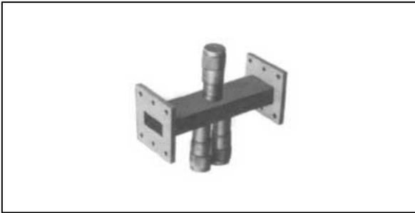
方形導波管内の電界に平行に金属丸棒スタブを入れると、共振長以下の長さの場合には容量性、それ以上のときは誘導性のサセプタンスとして作用します。
