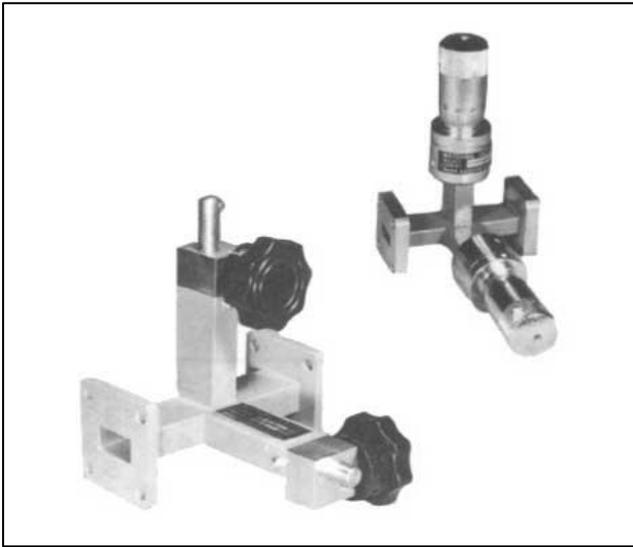
本器は方形導波管の一点にE分岐とH分岐とを設け、おのにおに可動短絡器を組み込んだもので、その短絡面を移動させることによって、直列リアクタンスや並列サセプタンスを全範囲に変化させることができます。
