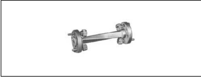
本器は方形導波管を管軸中心に90度回転させたものであって、偏波面をねじる必要のある場合に用います。ねじりに起因する反射や損失の増加を極力小さくするように設計されています。
