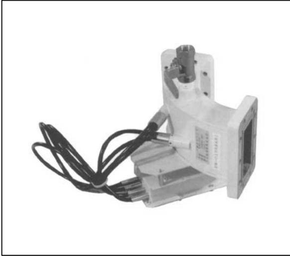
本器は大電力送信機の真空管や立体回路素子を導波管伝送路で発生したアーク放電から保護するための検出器です。
