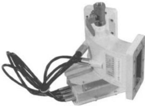
本器は大電力送信機の真空管や立体回路素子を導波管伝送路で発生したアーク放電から保護するための検出器です。構造は導波管内面にアーク放電を検出するための光センサーと万一放電が起こった時、そのアーク光を電気信号に変化させるための増幅器から成り立っています。増幅器の出力は送信機のインターロック回路に使われます。増幅器と導波管はオプティカルファイバーで接続されていますので、各種導波管に対応したものが製作できます。増幅器の電源は付属していませんが、ご用命があれば製作いたします。
