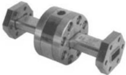
本器は、原子核物理や核融合の大電力伝送路の耐電力を上げるために、発振器と負荷との間にウインドを入れて一方を真空に、他方を加圧して使用する時に用います。
