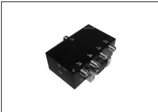
本器は、6GHz帯のSP4T型ピンダイオードスイッチです。無反射型ですので非接続ポートは50Ω終端されます。1W CWのマイクロ波を通すことができます。またポート毎の挿入位相差を小さく抑えています。
