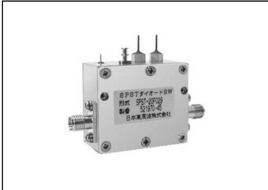
本器は、3GHz帯のSPST型のピンダイオードスイッチで、TTL信号によりマイクロ波のON/OFF制御が行えます。2W CWの通電切替が可能です。パルスモジュレーション用に適しています。
