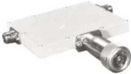
スラブラインの内外導体間に電波吸収体をさし入れることによって減衰量を連続的に変化させるもので他の方式と比較して小形で動作も安定しています。減衰量は吸収体の挿入長を示す目盛りから、校正表を使って求められます。
