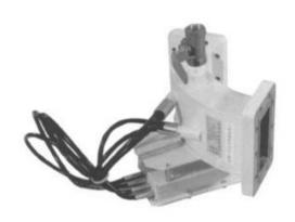
本器は大電力送信機の真空管や立体回路素子を導波管 伝送路で発生したアーク放電から保護するための検出 器です。構造は導波管内面にアーク放電を検出するための光センサーと万一放電が起こった時、そのアーク 光を電気信号に変化させるための増幅器から成りたっています。増幅器の出力は送信機のインターロック回路に使われます。増幅器と導波管はオプティカルファイバーで接続されていますので、各種導波管に対応したものが製作できます。増幅器の電源は付属しておりませんが、ご用命があれば製作いたします。
