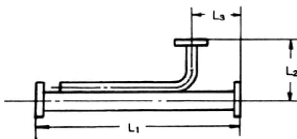
本多孔形方向性結合器は周波数特性が平坦なため、広帯域にしようされ、結合度もはるかに密にできます。よって高精度を求める測定に使用できます。
