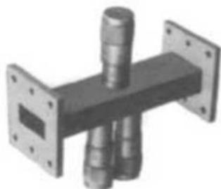
方形導波管内の電界に平行に金属丸棒スタブを入れると、共振長以下の長さの場合には容量性、それ以上のときは誘導性のサセプタンスとして作用します。本器はこの可変長スタブ三個を方形導波管長辺の中央に配置したもので、使用周波数帯域内で負荷インピーダンスの整合が可能です。したがって各種回路の入ラインピーダンス整合器として使用されます。
