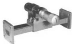
本器は導波管内の誘電体の相対位置をかえることにより、等価的線路長を $\lambda_g/2$ ( $1/2$ 管内波長)の諸範囲内で任意に調整することができます。移相器は、プラズマやアンテナの諸特性測定のためのブリッジ回路に組み込まれたり、発振器の合成回路の位相合わせ回路などに組み込まれて使用されています。
