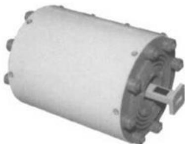
本器は立体回路装置の電源側と負荷側間で、直流電位差を付ける必要がある場合に用いられます。直流分をカットし、高周波成分のみを通すように設計されています。
