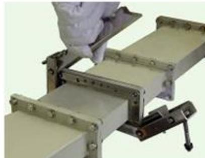
3 ナットを締付けて固定
