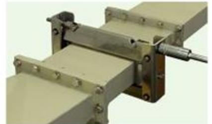
トルクレンチを使用して規定トルクで締付ける
