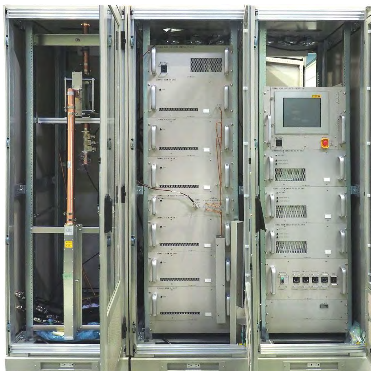
238MHz 42kWパルス高周波増幅器
