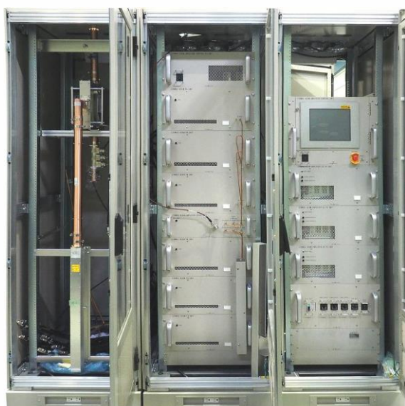
238MHz 42kW パルス高周波増幅器
