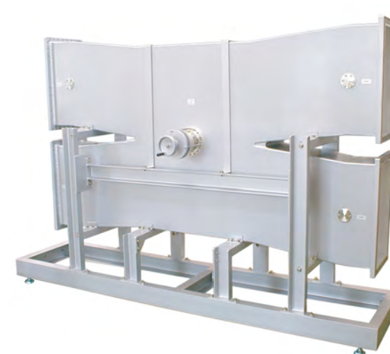
電力分割器 ・キャパシティブ・ドーム の調整による分割比可変型 可変範囲：3±0.2dB
