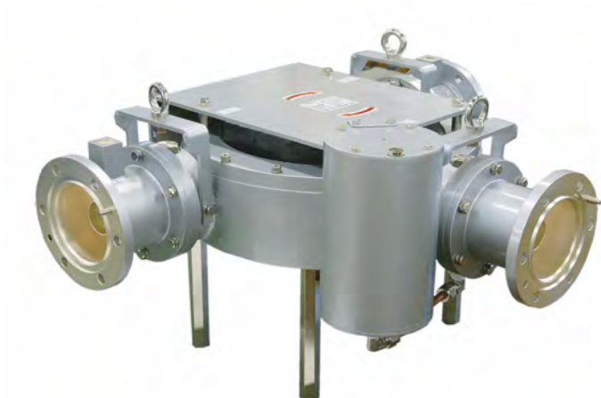
476MHz同軸管サーキュレータ 80kWpeakに耐える構造 絶縁油充填方式
